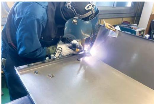
熟練された溶接技術で鉄・ステンレス・アルミの部品を溶接し一つの大きな製品へと仕上げる
