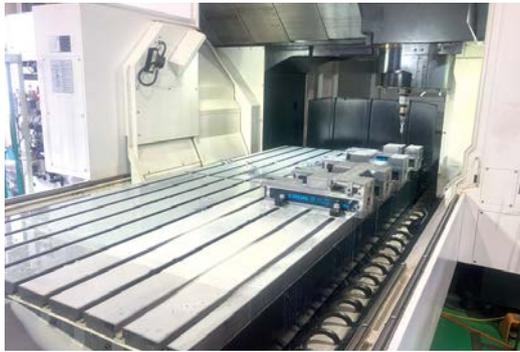
長さ3m幅1.5mの大型マシニングセンタを導入し大物の機械加工品や溶接品の削り加工を行っている
