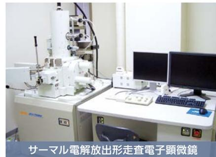
サーマル電解放出形走査電子顕微鏡
