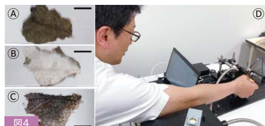
図4 反射スペクトルの測定に供したヒラメの有眼側A及び無眼側B、キツネメバルCの剥離摘出表皮と測定風景D、Dは長さ2cm
