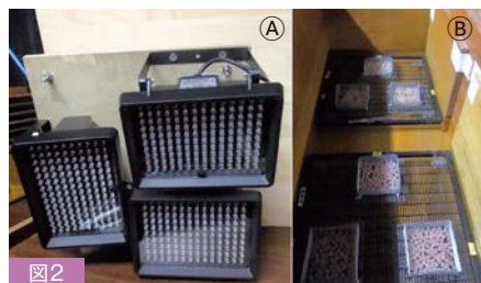
図2 サケ受精卵への近赤外線光照射実験に供したLEDランプAと孵化槽中の受精卵B
